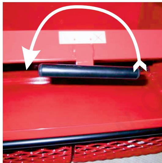
Der Bedienungsgriff wird jetzt gegen den Uhrzeigersinn gedreht, bis der Schieber durch die Dosierscheibe gestopt wird. Es ist wichtig, da der Bedienungsgriff immer von der geschlossenen Stellung gegen den Uhrzeigersinn gedreht wird, bis der Schieber von der Dosierscheibe gestopt wird, wenn eine gleichartige Öffnung wieder erreicht werden soll.
