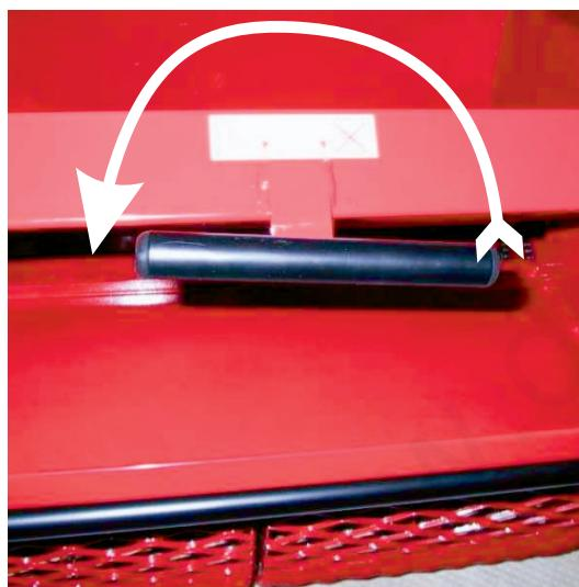
Agir sur le levier de commande jusqu'à la butée pour ouvrir la distribution.
