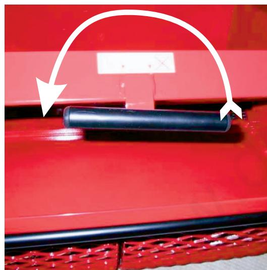
Betjeningsgrebet drejes nu mod uret, til skoddet stoppes af doseringsskiven. Det er vigtigt, at betjeningsgrebet altid drejes fra lukket stilling og mod uret, til skoddet stoppes af doseringsskiven, hvis ensartet åbning skal opnås.
